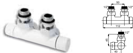
ПРАВЫЙ ПРЯМОУГОЛЬНЫЙ ВЕНТИЛЬ KRISTAL, МЕЖОСЕВОЕ РАССТОЯНИЕ МЕЖДУ ТРУБАМИ 50 MM, БЕЛЫЙ R01 - RAL 9010 KRISTAL VALVE SQUARE RIGHT PIPE CENTRES 50 MM WHITE R01 - RAL 9010
